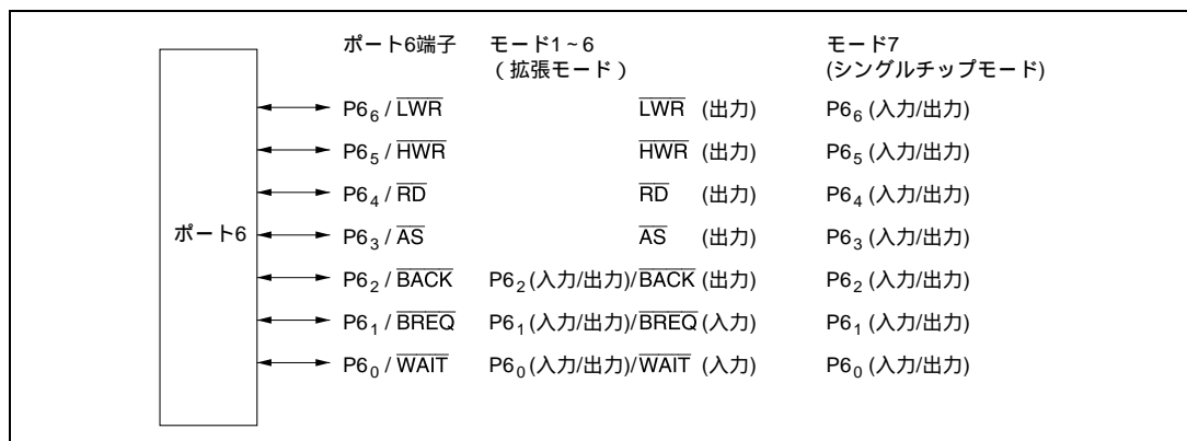
図 9.6 ポート 6 の端子構成
