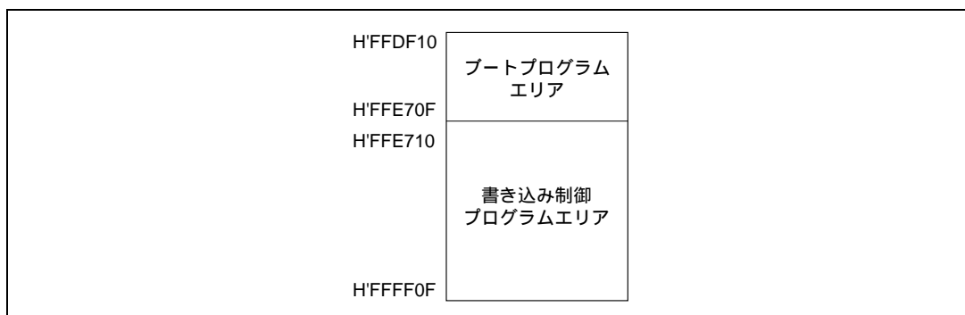
図 18.7 ブートモード時の RAM エリア
