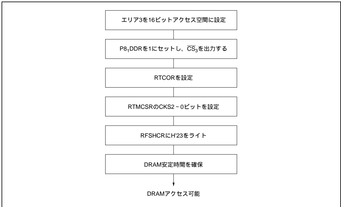
図 7.10 2WE 方式 4M ビット DRAM (10 ビットロウアドレス × 8 ビットカラムアドレスの場合) の設定順序 (16M バイトモード)
