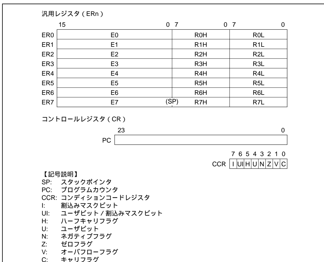
図 2.3 CPU 内部レジスタ構成
